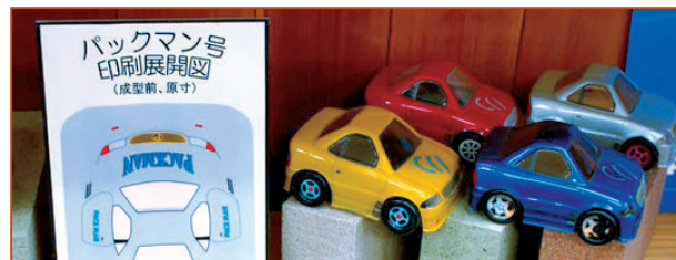
ペット素材に展開図をプリント&真空成型して完成
