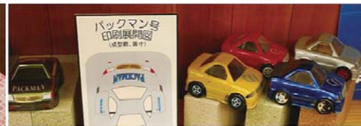
ペット素材に展開図をプリント & 真空成型して完成。
