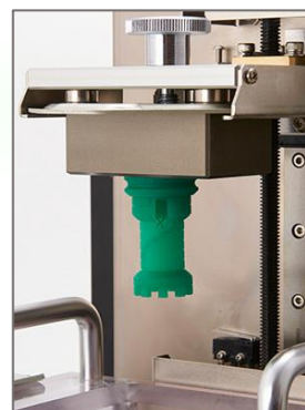
積層造形に吊下げ方式を採用
