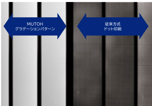
MUTOH独自の導光板ダイレクト印刷技術「グラデーションパターン」
