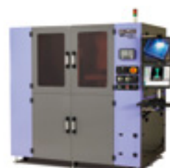
産学共同開発： アーク溶接方式を採用した新コンセプトの金属3Dプリンタ 「ValueArc MA5000-S1」
